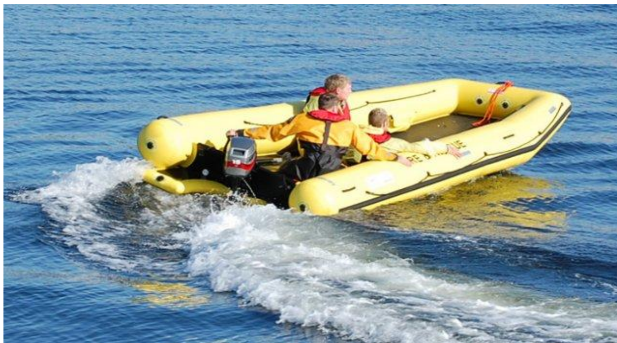
Tratwa Ratownicza wyposażona jest w miejsce mocowania silnika zaburtowego
